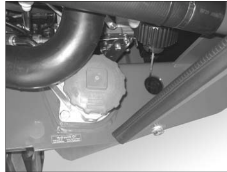
Abb. 51 Abbauen des Restdrucks
